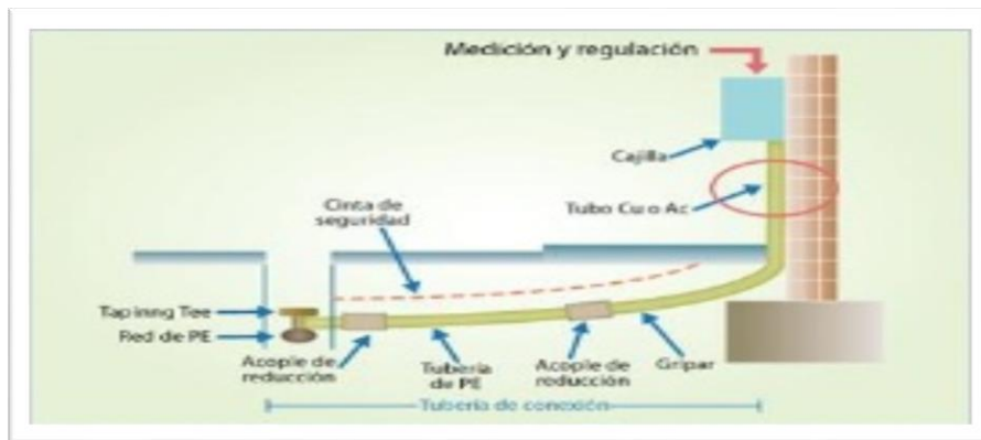
Figura 11: Conexión de la acometida al gabinete de regulación y medición
