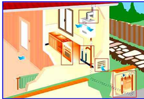
Figura 15: Ingreso de aire para la buena combustión
